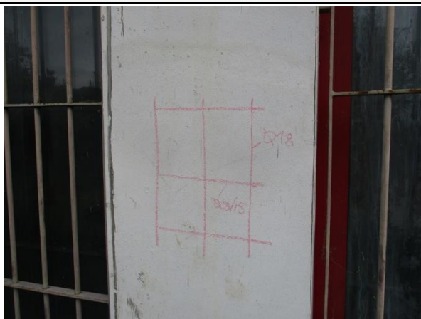
Particolare dell'analisi pacometrica effettuata sul Pilastro B012
